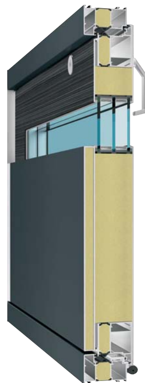
Grâce à l'utilisation de panneaux d'une épaisseur de 85 à 105 mm et d'une zone d'isolation augmentée de 20 mm avec garniture isolante, la nouvelle série certifiée Passivhaus (maison passive) peut offrir des valeurs Ud à partir de 0,67 W/m 2 K seulement.
