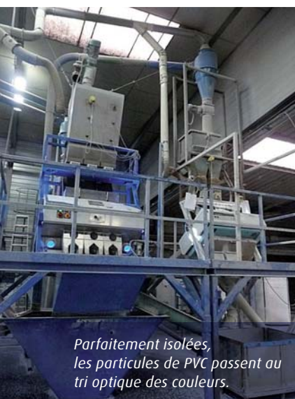
Métaux non ferreux puis particules ferreuses sont écartées, la matière de plus en plus finement broyée est triée.
