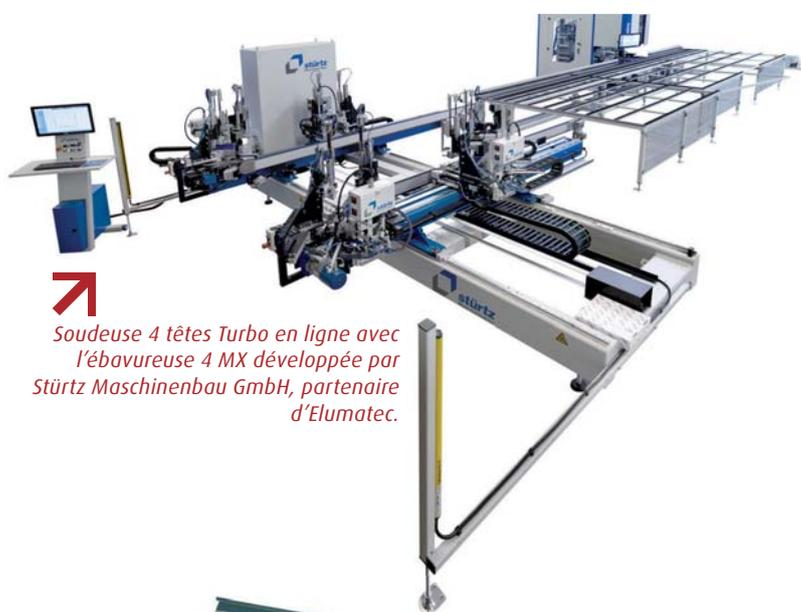
Soudeuse 4 têtes Turbo en ligne avec l'ébavureuse 4 MX développée par Stürtz Maschinenbau GmbH, partenaire d'Elumatec.
