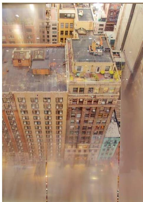
*Vision Control Film du japonais Wincos est un film dont la polarisation varie de transparent à translucide avec l'angle de vision. Il se pose horizontalement ou verticalement, sur la face intérieure des vitrages. Les emplois sont multiples, mais il contribue notamment à éviter les sensations de vertige dans les tours équipées de vitrages hauteur d'étage. Doc. PP*
