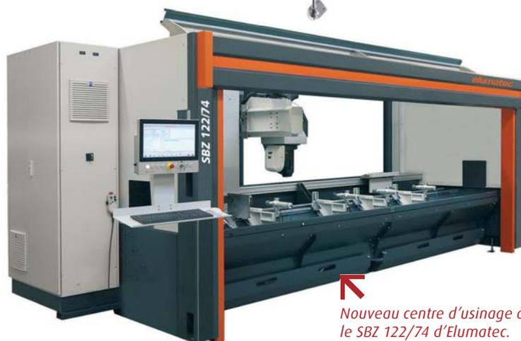
Nouveau centre d'usinage à 4 axes, le SBZ 122/74 d'Elumatec.
