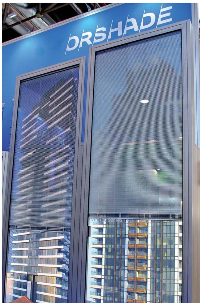
Orshade propose des BSO incorporés aux vitrages pouvant atteindre jusqu'à 9 m<sup>2</sup>. Il offre également les motorisations nécessaires, les interfaces vers un bus de terrain KNX et IP. Doc. PP
