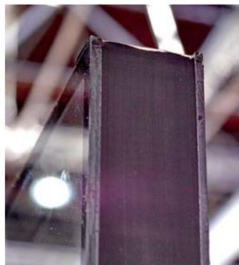
Climatop Easy de Saint-Gobain Glass est une nouvelle solution d'espaceur pour triple vitrage avec un seul espaceur au lieu de deux. Sur la face intérieure de l'espaceur, une encoche au centre accueille un vitrage intermédiaire de 2 mm d'épaisseur au lieu de 3. Le gain de poids peut atteindre 25% par rapport à un triple vitrage classique avec deux espaceurs. Doc. PP
