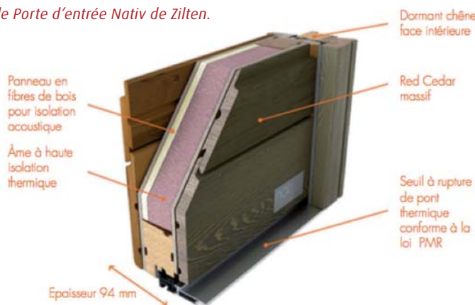
Coupe de la nouvelle Porte d'entrée Nativ de Ziltén.
