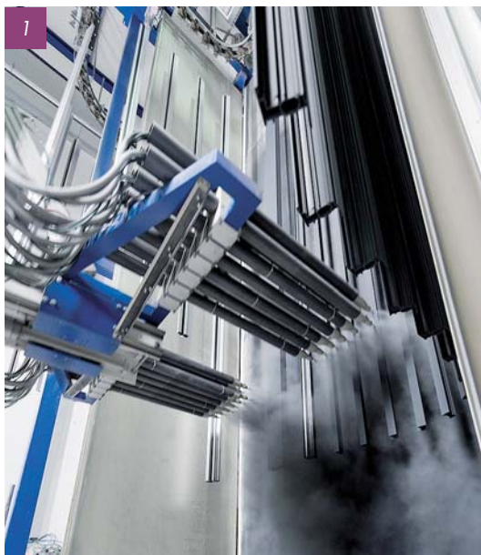
1 - La poudre de laquage HWR est appliquée par 2 jeux de 12 pistolets.
