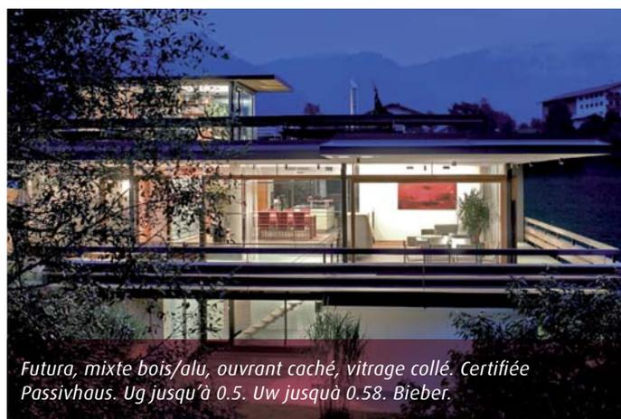
Futura, mixte bois/alu, ouvrant caché, vitrage collé. Certifiée Passivhaus.  $U_g$  jusqu'à 0.5.  $U_w$  jusqu'à 0.58. Bieber.
