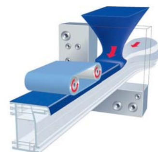
Coextrusion des profilés Acrylcolor. Poitou Menuiseries.
