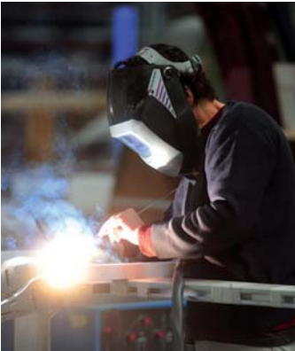
Les portails alu de Gyt sont mécano-soudés.
