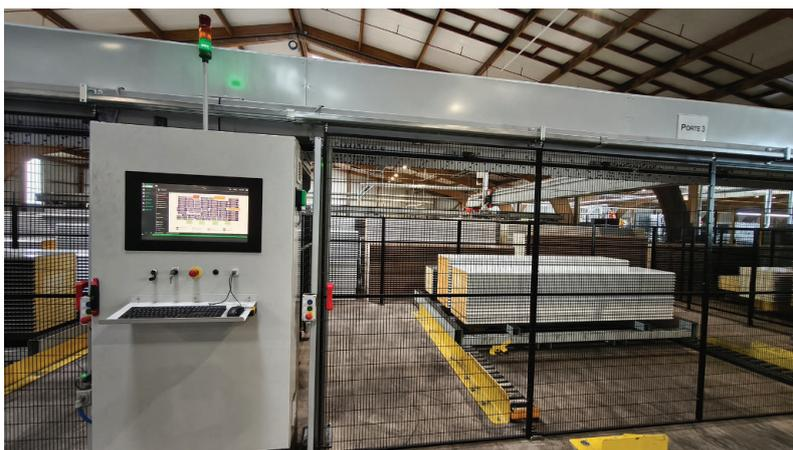
*Le nouveau stockeur automatisé gère 150 références différentes de panneaux, contient 3000 panneaux. Ce qui représente environ 700 portes. Sa mise en route a engendré un gain de productivité de 30% dans la fabrication des portes de garage et une augmentation de la qualité. Doc. PP*
