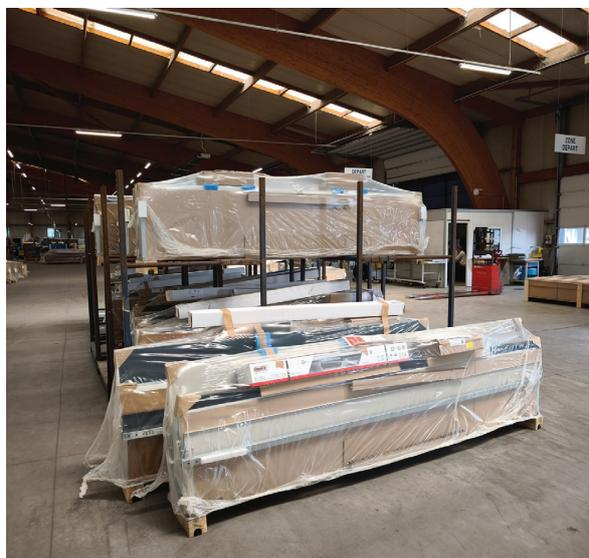
Pour ses clients, SPI prépare des colis complets avec tous les produits et accessoires pour installer les portes sur chantier. Un tunnel à 200°C se charge de l'emballage thermo-rétractable des colis, qui sont ensuite rassemblés avant expédition. Doc. PP
