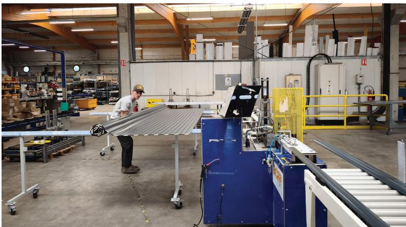
*La ligne de perçage et d'usinage des panneaux est tout à fait spécifique : la belle face des panneaux se trouve sur le dessus pour éviter les dégradations lors du percement. Un panneau pèse environ 12 kg/ml. Doc. PP*
