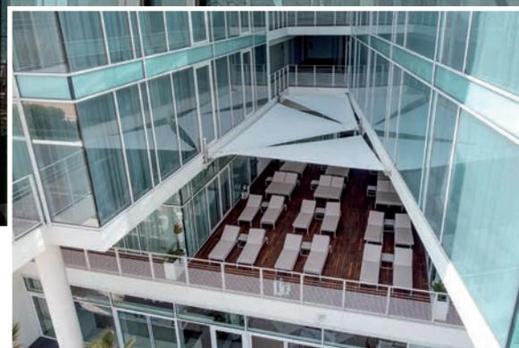
*Trois voiles d'ombrage Kheope (80 m<sup>2</sup> de couverture) motorisées et équipées d'un anémomètre pour assurer une fermeture automatique en cas d'intempéries ont été installées sur la terrasse de L'hôtel Jesolo situé sur la riviera vénitienne. ©KE*
