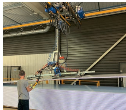
La table élévatrice de plaques dédiées à la fabrication des toitures de vérandas permet de limiter la pénibilité du travail des opérateurs.
