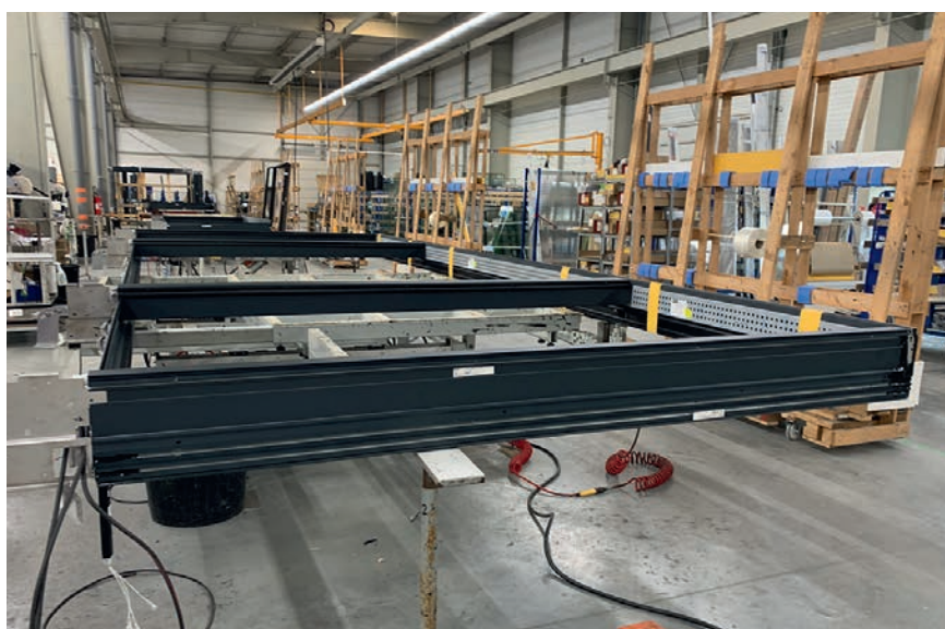
Les tables de montage permettent l'assemblage et l'intégration de tous les composants du projet.
