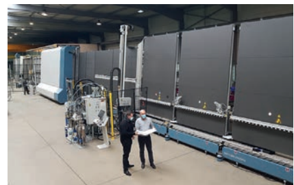
Le tout dernier investissement de Diffuver : 56 m de technologie Lisec incluant une table de coupe pour verre feuilleté avec un pont de 6 m, deux centres d'usinage et une ligne de vitrage isolant Jumbo (grands volumes) dernière génération.
