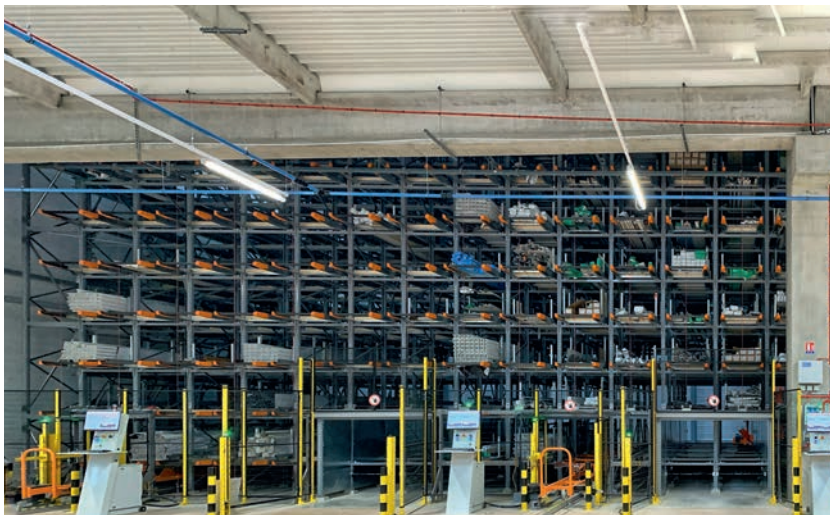
Le nouveau transstockeur d'une capacité de 300 alvéoles destinées au stockage des profils PVC et alu.
