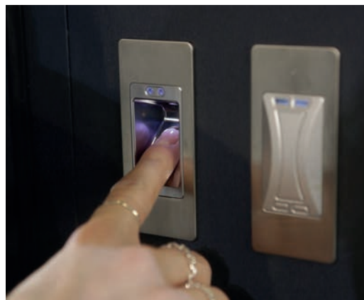
Contrôle d'accès à lecteur d'empreinte sur la porte Soleal 65. ©Technal.
