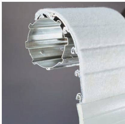
Axis 50 avec verrou tasseur aluminium recouvert de feutrine. ©Saprofen.
