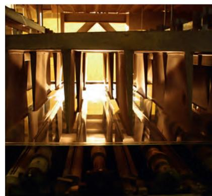
*Après le float, le ruban de verre pénètre dans l'étenderie. C'est une série de fours thermiques couverts ou découverts qui vont gérer le refroidissement du verre à un rythme précis. Le verre sort du float à 600°C, passe par une zone à 230°C et atteint la fin de l'étenderie à 60°C.*
