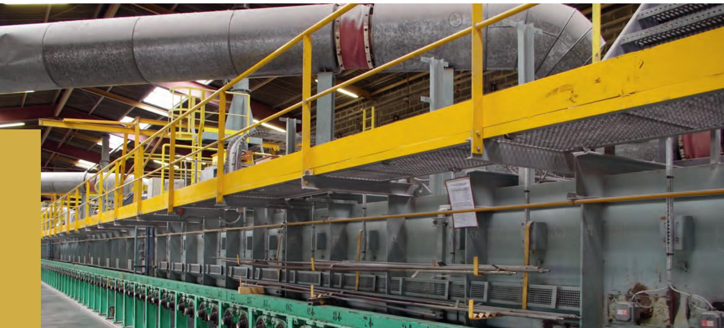
L'usine de AGC Glass de Boussois fonctionne au gaz naturel. La température du verre dans le bassin de fusion atteint 1600°C.
