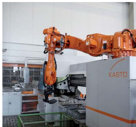
Centre logistique de Kasto avec robot, relié à une cellule de sciage.
