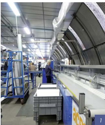
1 - Ligne automatisée de coupe des lames et assemblage des tabliers de volets roulants.
