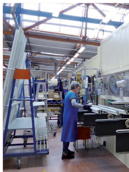
Centre d'usinage Elumatec, encoffré pour favoriser un environnement de travail moins bruyant.
