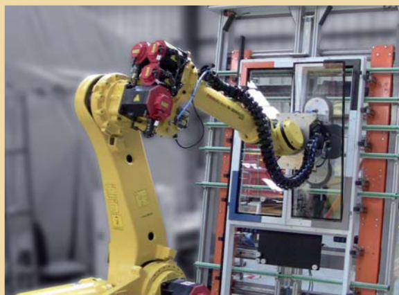
Démonstration sur le stand Tecauma de son robot de vitrage sur menuiserie complète.
