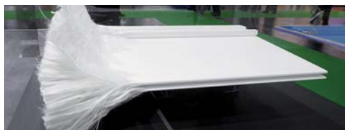
Polyester et fibre de verre pultrudés. Fiberline Composites A/S.
