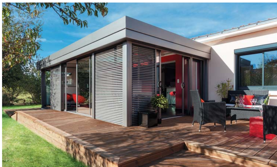
Effet toiture terrasse pour la collection Epure de Véranda Rideau. L'inclinaison de la toiture de 5 % à 12 % est dissimulée par la corniche acrotère
