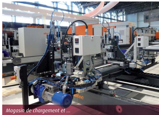
Centre d'usinage SBZ 617 d'Elumatec, pour Alu et PVC.
