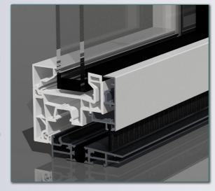
La disposition originale de l'ouvrant fait qu'il est entièrement dissimulé par le dormant. Dans cette configuration, seul le dormant est concerné par la coloration : 1 seul profil à traiter au lieu de 2 habituellement. De plus le dormant est entièrement capotable en aluminium, REFERENCE propose alors, à partir d'une gamme PVC une esthétique extérieure 100% Alu.
