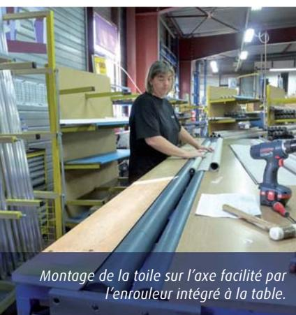
Montage de la toile sur l'axe facilité par l'enrouleur intégré à la table.
